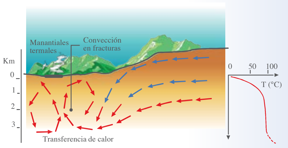
Figura 8 Esquema de la circulación del agua en un sistema controlado por una falla 10
